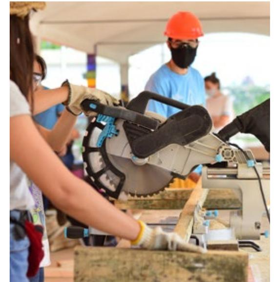
Imagen 08. Estación de corte de alfajías de madera.
