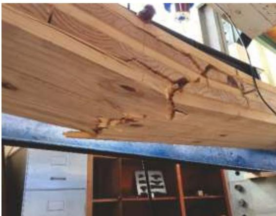
Se fabricaron paneles de 3 y 5 capas con distintas configuraciones de espesores de tabla en cada capa con el fin de ensayarlos experimentalmente y tener una primera estimación de sus propiedades estructurales y su posible uso como entrepiso en edificación. La Fig.7 muestra los ensayos de flexión de cuatro puntos realizados y la forma de rotura de los paneles.
